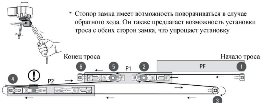
Затем затяните трос и установите его на другой фиксатор с замком.
