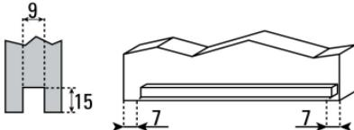
Для деревянных полотен нужно профрезеровать нижнюю часть двери для поводка
