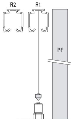
Установите нижний поводок в конце фиксированной панели, как показано на схеме.
