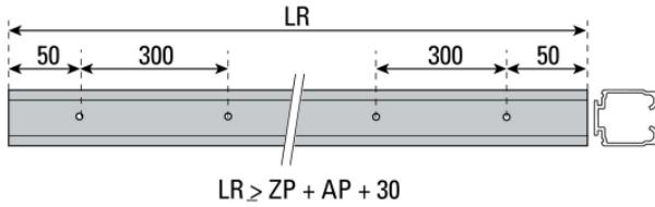
Вставьте каретки и стопора в оба конца направляющей 1 (R1) как показано на схеме
