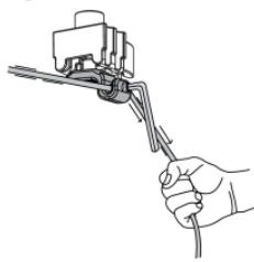
**!** В случае надобности замок может быть демонтирован с пластины и собран другой стороной. Для этого вам нужно нажать на выступы в пластине, как показано на схеме.
