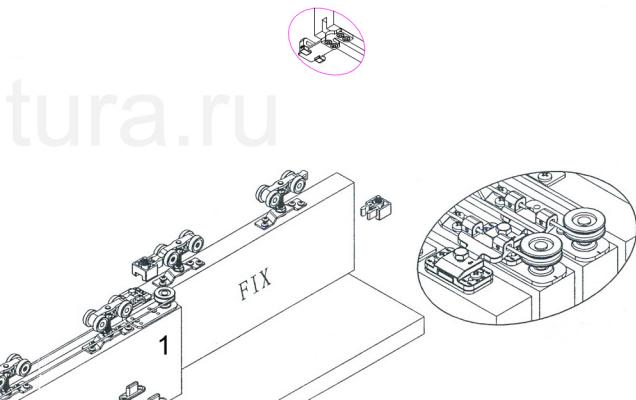
При правильной установке в зоне парковки все полотна должны стоять заподлицо. В выдвинутом состоянии, нахлест между полотнами по 60 мм.
