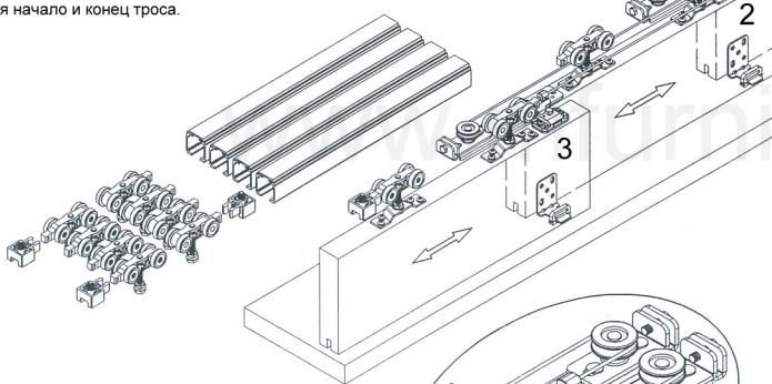
После установки троса, он натягивается натяжителем при помощи винта в ролике троса натяжителем 2 на первом и втором полотнах.
